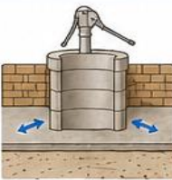
Pose de la pompe à volant - puits terminé
